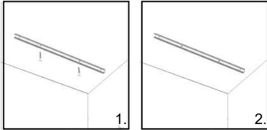
2 Вставьте закреплённые жесткие профили в пазухи светильников, затем поместите электрические разъемы между светильниками.
