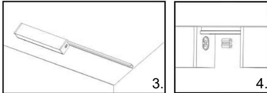
3 Электрический соединитель предназначен для подключения светильников в одну цепь. Поэтому, когда в одну электрическую цепь светильники подключать не нужно, просто соедините их с помощью жестких профилей, но без электрического соединителя.
