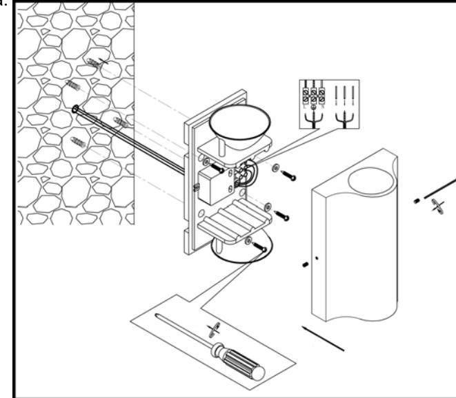
!!!Позаботьтесь, чтобы избежать повреждения любой скрытой проводки и труб. Для кирпичных и гипсокартонных стен должен использоваться соответствующий крепеж.
