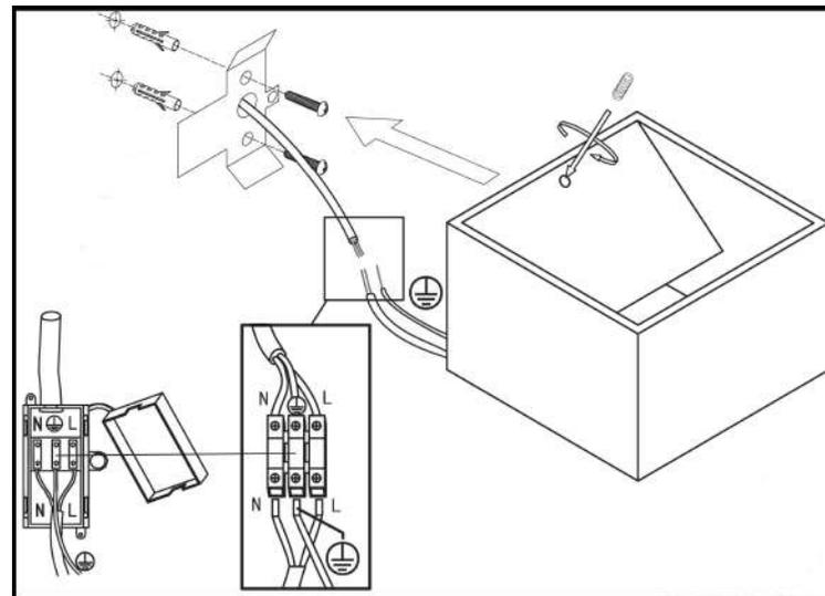
!!!Позаботьтесь, чтобы избежать повреждения любой скрытой проводки и труб. Для кирпичных и гипсокартонных стен должен использоваться соответствующий крепеж.
